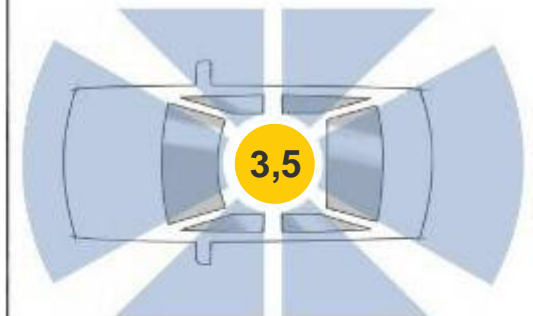
Breite Dachsäulen schränken die Sicht nach schräg hinten erheblich ein.
