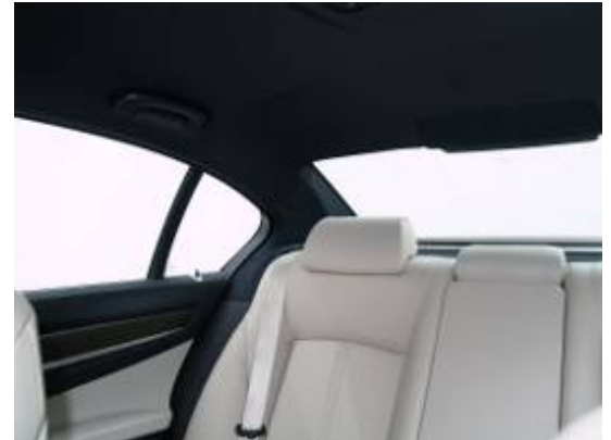
Aufgrund der breiten Dachsäulen und der hohen Gürtellinie mit schmalen Fensterflächen ist die Sicht arg eingeschränkt.
