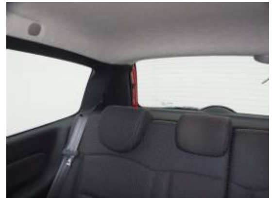
Schmale Dachsäulen sowie versenkbare Kopfstützen erleichtern die Sicht nach hinten besonders.
