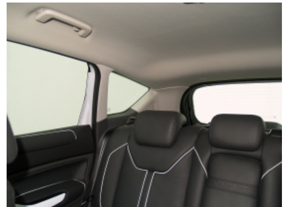
Trotz der versenkbaren Kopfstützen im Fond ist die Sicht nach schräg hinten aufgrund der breiten Dachsäulen stark eingeschränkt.
