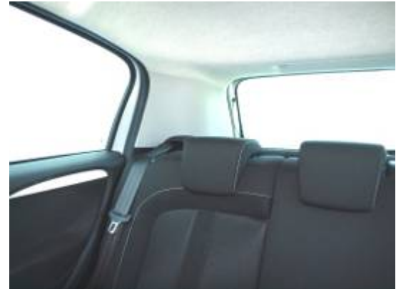
Die breiten C-Säulen schränken die Sicht nach schräg hinten beträchtlich ein.
