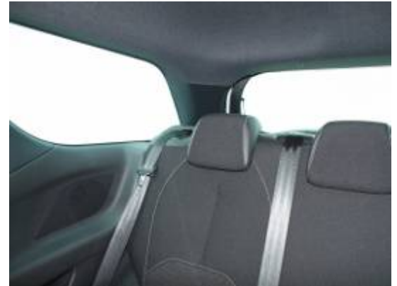
Die breiten Dachsäulen und die hohe Fensterlinie schränken die Sicht nach schräg hinten besonders ein.
