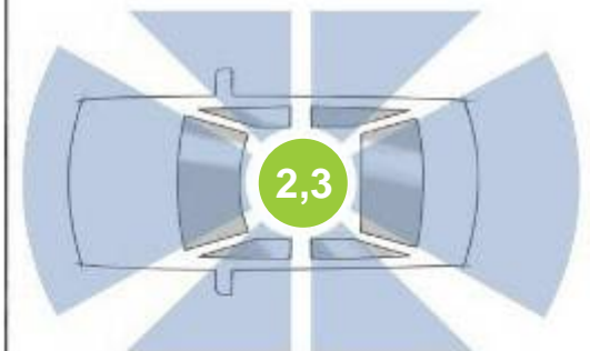
Die breiten Dachsäulen und die hohe Fensterlinie schränken die Sicht nach schräg hinten besonders ein.
