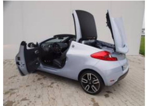
Komfortabel: Das Kunststoff-Klappdach öffnet und schließt jeweils in nur zehn Sekunden.
