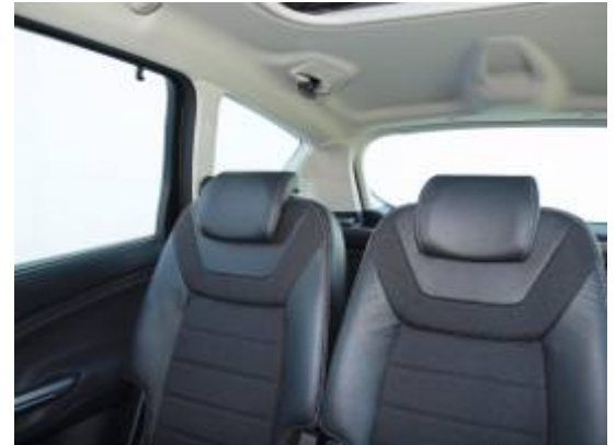
Versenkbare Kopfstützen und große Fensterflächen erleichtern die Sicht nach schräg hinten.
