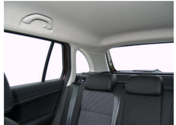
Versenkbare Kopfstützen erleichtern die Sicht nach hinten.
