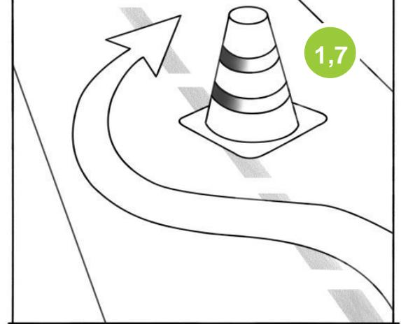
Beim ADAC-Ausweichtest erfolgt die Einfahrt in die Pylonengasse mit einer Geschwindigkeit von 90 km/h bei mindestens 2000 Motorumdrehungen im entsprechenden Gang. Geprüft wird die Fahrzeugreaktion, d.h. die Beherrschbarkeit beim anschließenden Ausweichen.
