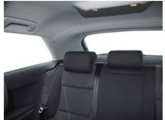
Aufgrund der relativ breiten Dachsäulen ist das Sichtfeld im A3 recht eingeschränkt.
