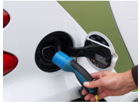
Hinter dem Tankdeckel befindet sich der Stromanschluss. Das Fahrzeug kann an der haushaltsüblichen Steckdose aufgeladen werden.
