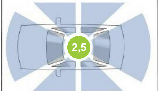
Versenkbare Kopfstützen und nicht zu breite Dachsäulen erleichtern die Sicht nach hinten.
