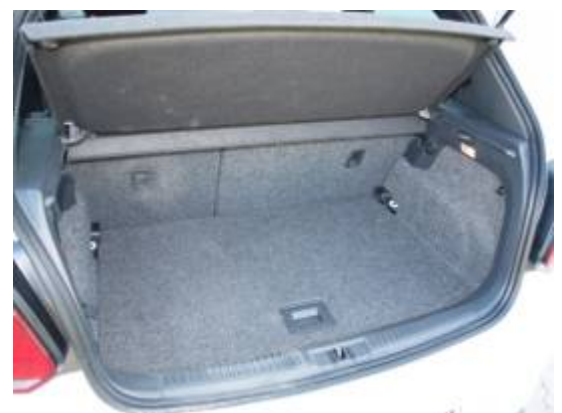
Das serienmäßig verbaute Ersatzrad beim Polo GTI verringert das Kofferraumvolumen von 240 auf 180 Liter.
