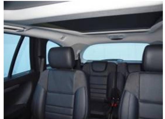
Breite Dachsäulen und nicht versenkbare Kopfstützen der zweiten Sitzreihe beeinträchtigen die Sicht nach hinten.
