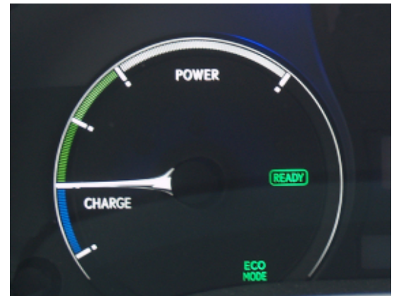
Das linke Rundinstrument im Fahrerdisplay informiert über die Aktivität des Hybridsystems.
