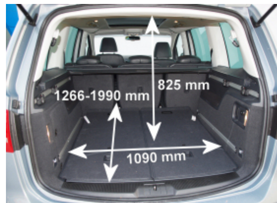
Das Kofferraumvolumen bei fünf Sitzplätzen ist gegenüber dem Vorgängermodell zwar um 55 Liter kleiner ausgefallen, ist aber mit 755 Liter immer noch riesig.
