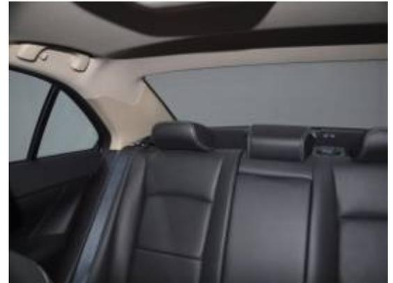
Breite Dachsäulen erschweren die Sicht nach schräg hinten.
