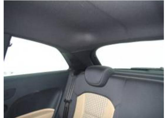
Versenkbare Kopfstützen und nicht zu breite Dachsäulen erleichtern die Sicht nach hinten.
