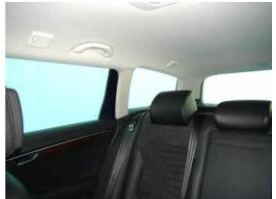
Nicht versenkbare Kopfstützen stören die Sicht nach hinten.
