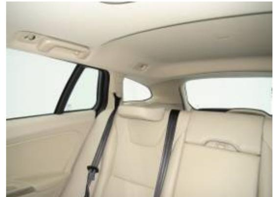
Per Knopfdruck versenkbare Kopfstützen erleichtern die Sicht nach hinten.
