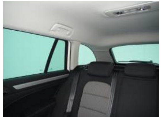
Versenkbare Kopfstützen erleichtern die Sicht nach hinten.
