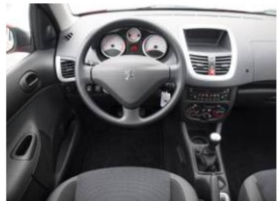
**Die Regler für Heizung und Lüftung sind wie bei vielen Fahrzeugen zu tief und außerhalb des Sichtbereichs angebracht.**
