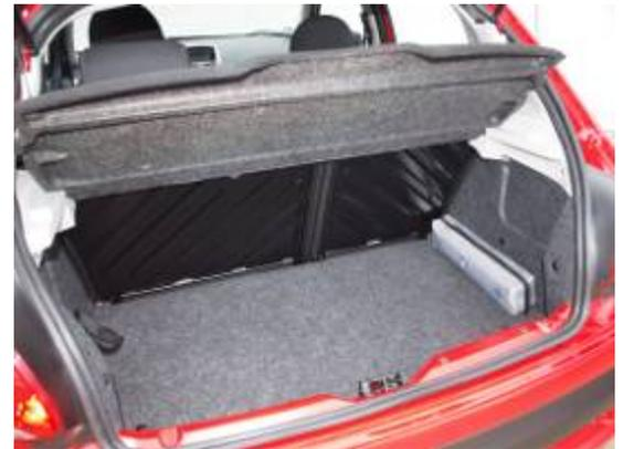
**Der Kofferraum ist mit 255 l Gesamtvolumen in dieser Fahrzeugklasse nur von durchschnittlicher Größe.**
