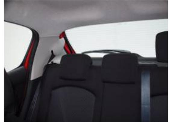
Versenkbare Kopfstützen und nicht zu breite Dachsäulen erleichtern die Sicht nach schräg hinten.
