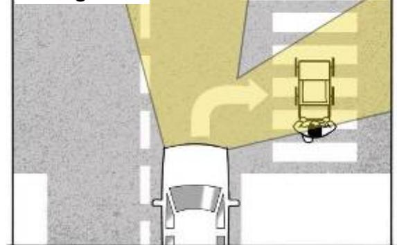
Zusätzliche Lampen (oder angepasste Nebelscheinwerfer) leuchten im Stadtverkehr beim Abbiegen die betreffende Seite besser aus. So wird das Risiko, an Kreuzungen und Einmündungen Fußgänger zu übersehen, erheblich vermindert.
