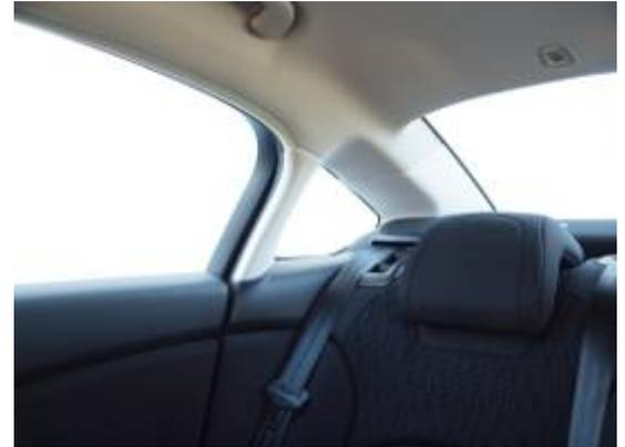
Versenkbare Kopfstützen erleichtern die Sicht nach hinten.
