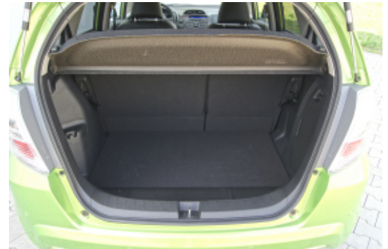
Trotz verstaubar Batterien unter dem Kofferraumboden stehen immer noch 260 l Volumen zur Verfügung.
