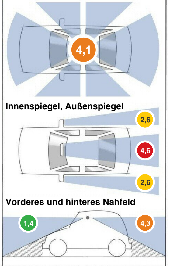
Die Rundumsicht-Note informiert über die Sichtbehinderung des Fahrers durch Fensterposten und Kopfstützen. Bei den Innen- und Außenspiegeln werden deren Sichtfelder aus dem Blickwinkel des Fahrers bewertet. Die Noten des vorderen und hinteren Nahfeldes zeigen, wie gut der Fahrer Hindernisse unmittelbar vor bzw. hinter dem Fahrzeug erkennt.
