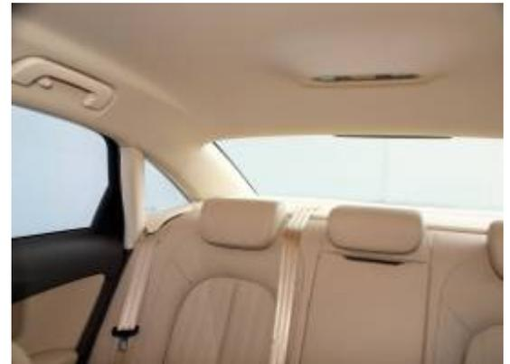
Versenkbare Kopfstützen erleichtern die Sicht nach hinten.
