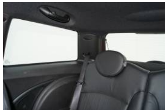
Breite Dachsäulen und nicht versenkbare Kopfstützen verhindern eine gute Sicht nach schräg hinten.
