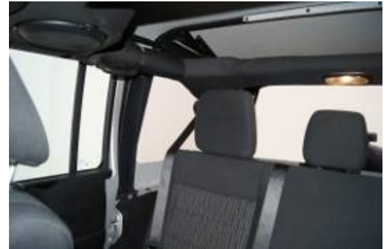
Breite Dachsäulen und nicht versenkbare Kopfstützen erschweren die Sicht nach schräg hinten.
