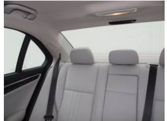
Die Sicht nach schräg hinten wird durch breite Dachsäulen und nicht versenk- oder klappbare Kopfstützen beeinträchtigt.
