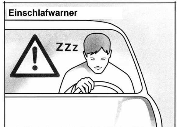
Ungewöhnliche Fahrerreaktionen aufgrund von Müdigkeit werden erkannt und führen zu einer Warnung.
