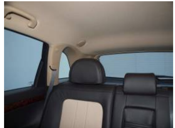
Breite Dachsäulen und nicht versenkbare Kopfstützen erschweren die Sicht nach schräg hinten.
