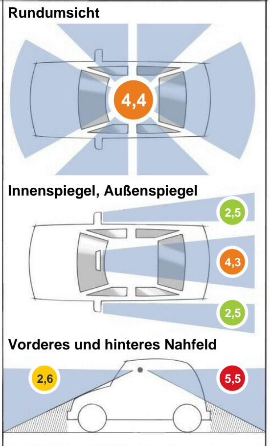
Die Rundumsicht-Note informiert über die Sichtbehinderung des Fahrers durch Fensterpfosten und Kopfstützen. Bei den Innen- und Außenspiegeln werden deren Sichtfelder aus dem Blickwinkel des Fahrers bewertet. Die Noten des vorderen und hinteren Nahfeldes zeigen, wie gut der Fahrer Hindernisse unmittelbar vor bzw. hinter dem Fahrzeug erkennt.
