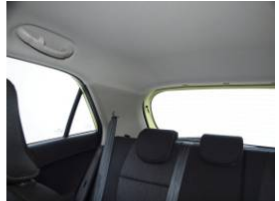
Trotz versenkbaren Kopfstützen wird die Sicht durch breite Dachsäulen eingeschränkt.
