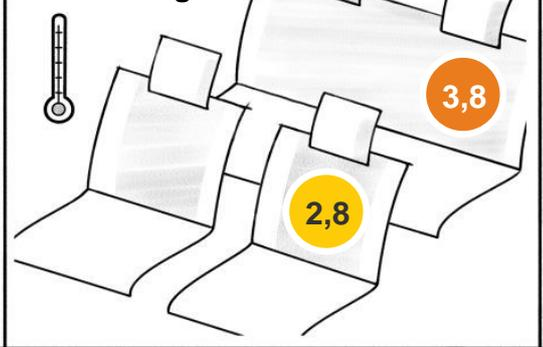
Aufwärmzeit von  $-10^{\circ}\text{C}$  auf  $+22^{\circ}\text{C}$
