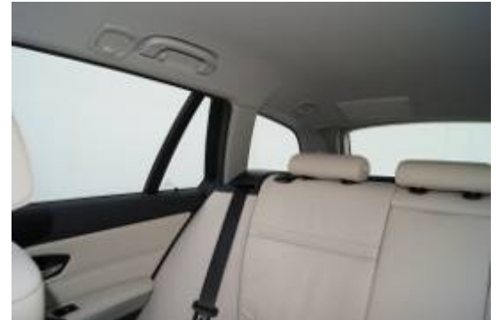
Die Sicht, im Besonderen nach schräg hinten, wird durch die hohe Fensterlinie und die breiten Dachsäulen eingeschränkt.
