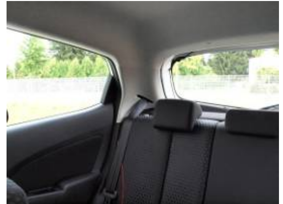
Der Blick nach schräg hinten wird durch breite Dachsäulen stark beeinträchtigt.
