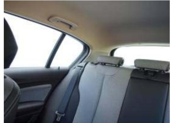
Breite Dachsäulen und eine relativ schmale Heckscheibe verhindern eine gute Sicht nach hinten.
