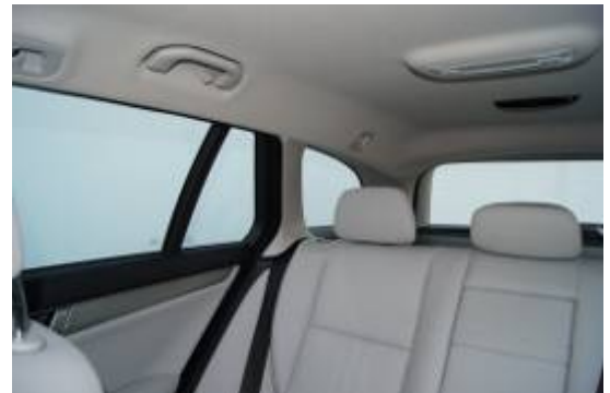
Die Sicht nach schräg hinten wird durch breite Dachsäulen und nicht versenk- oder klappbare Kopfstützen beeinträchtigt.
