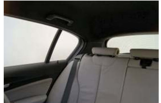
Breite Dachsäulen und eine relativ schmale Heckscheibe verhindern eine gute Sicht nach hinten.
