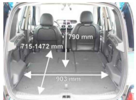
Mit 295 l Kofferraumvolumen bietet der Picasso mehr Platz für das Gepäck als die meisten Konkurrenten.
