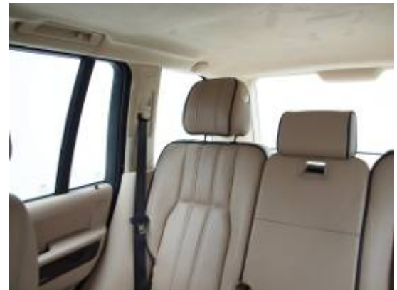
Breite Dachsäulen und nicht versenkbare Kopfstützen erschweren die Sicht nach schräg hinten.
