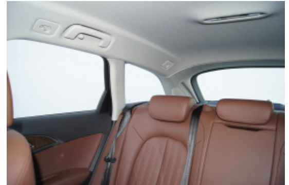
Versenkbare Kopfstützen und nicht zu breite Dachsäulen erleichtern die Sicht nach schräg hinten.
