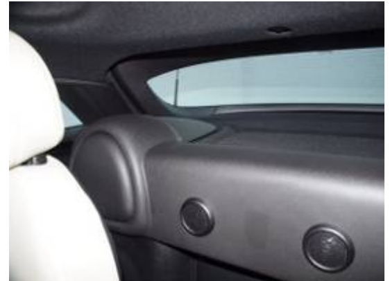
Breite Dachsäulen und die schmale Heckscheibe verhindern eine gute Sicht nach schräg hinten.
