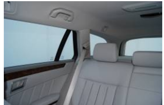
Die Sicht nach schräg hinten wird durch die nicht voll versenk- oder klappbaren Kopfstützen und die relativ breiten Dachsäulen beeinträchtigt.
