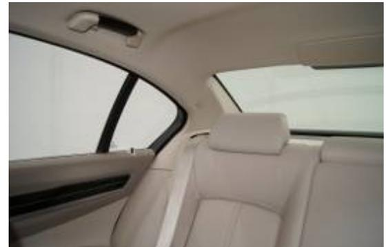
Aufgrund der breiten Dachsäulen und der hohen Gürtellinie mit schmalen Fensterflächen ist die Sicht arg eingeschränkt.
