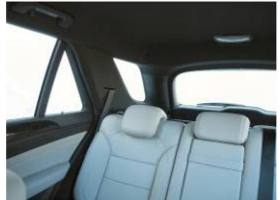
Versenkbare Kopfstützen erleichtern die Sicht nach schräg hinten.
