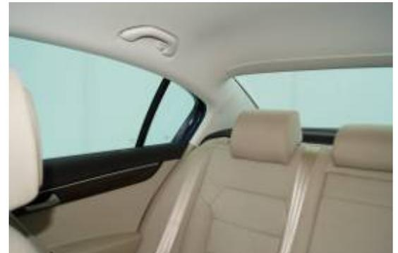
Nicht versenkbare Kopfstützen verhindern eine bessere Sicht nach schräg hinten.
