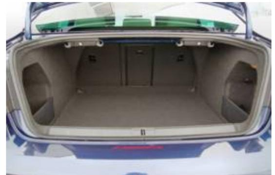
**Die Erdgastanks befinden sich unter dem Kofferraumboden und lassen für ein Ersatzrad keinen Platz mehr. Dadurch bleibt aber der Kofferraum mit 480 l Volumen auf Oberklasseniveau.**
