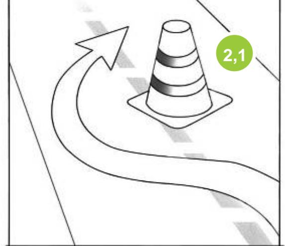
Beim ADAC-Ausweichtest erfolgt die Einfahrt in die Pylonengasse mit einer Geschwindigkeit von 90 km/h bei mindestens 2000 Motorumdrehungen im entsprechenden Gang. Geprüft wird die Fahrzeugreaktion, d.h. die Beherrschbarkeit beim anschließenden Ausweichen.
