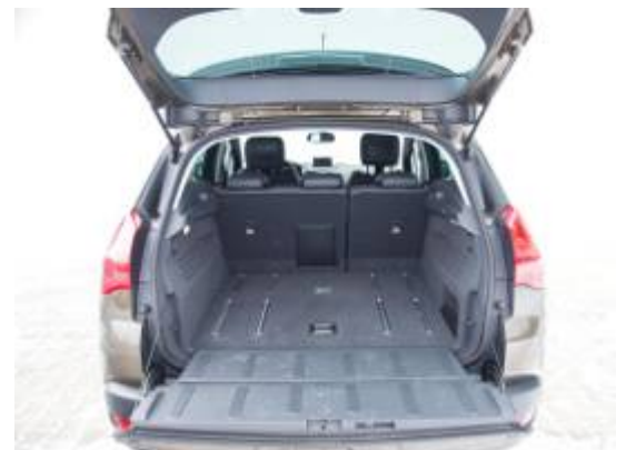
Die Hybrid-Komponenten brauchen Platz und verringern dadurch das Kofferraumvolumen um 100 l gegenüber Modellen mit konventionellem Antrieb (425 l).
