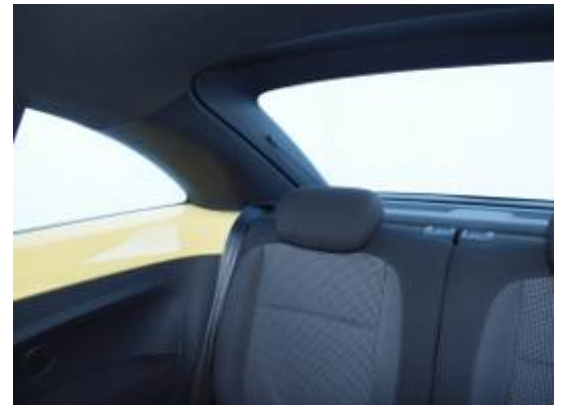
Versenkbare Kopfstützen verbessern die Sicht nach schräg hinten.
