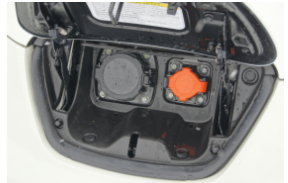
Unter der Ladeklappe befinden sich die Anschlüsse für Starkstrom und für die haushaltsübliche Steckdose.
