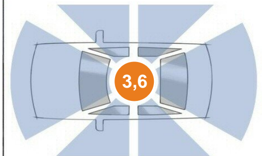
Breite Dachsäulen und die hohe Fensterlinie erschweren die Sicht nach schräg hinten.
